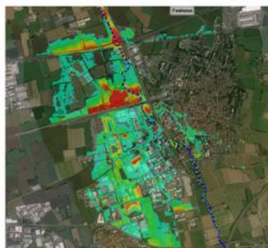
Figura 6 - risultati della modellazione idraulica 2023 a seguito delle modifiche morfologiche
