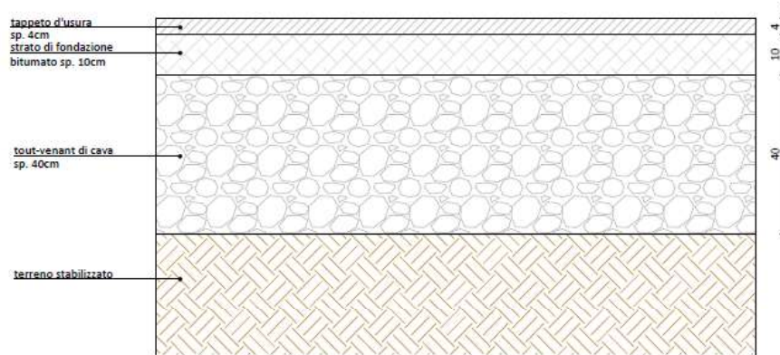
Sezione stratigrafia stradale di progetto
