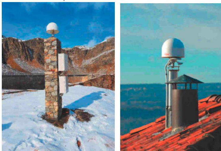
Figura 2 - Esempi di monumentazione di antenne geodetiche - Lago Agnel (AGNE), Biella (BIEL)
